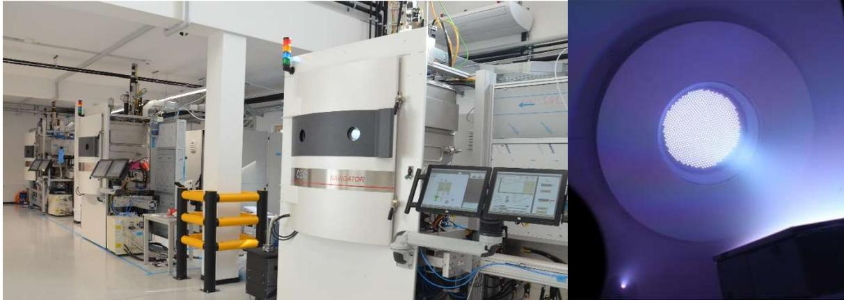
Die Cutting Edge Coatings GmbH stellt Anlagen für die Beschichtung optischer Komponenten mittels Ionenstrahl-Zerstäuben (IBS) her. Dieses Beschichtungsverfahren erreicht höchste Schichtqualitäten und wird daher bevorzugt für besonders anspruchsvolle Laseranwendungen eingesetzt.
