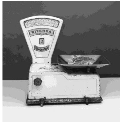
1924 Erste Neigungsschalt- gewichtswaage der Welt
